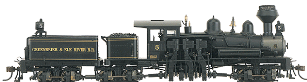
Echelle H0 - Classe C - 80 t. - 3 cylindres - 3 bogies moteurs.
