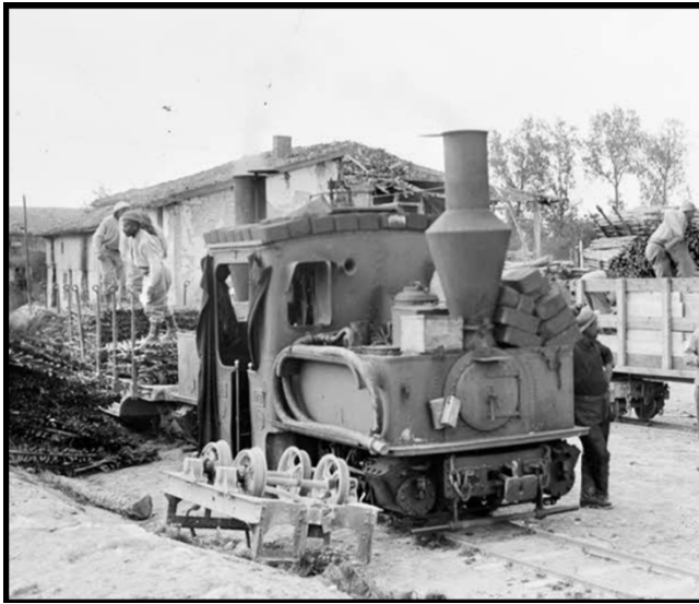
Réf. SPA 26 L 1277 – En gare de Virginy (Marne) une locomotive péchot-Bourdon attelée à une plate-forme Péchot chargée de fascines. 22 juillet 1916, Albert Samama-Chikli
