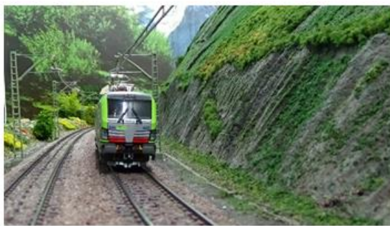
PHOTO 12 : ligne 37 – dans le fond le point d'arrêt de Chaudfontaine. A l'endroit de la prise de vue, le rayon de courbure est de 507 mètres. Entraxe évalué à 3,635 m. (N : 22,7 mm / HO : 42,8 mm).
