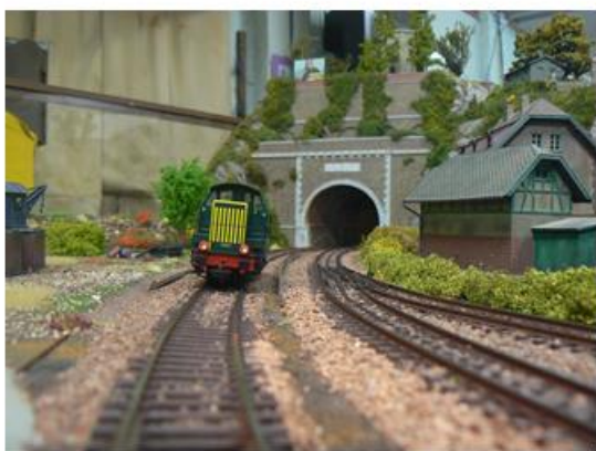
PHOTO 6 : réseau du club « gare de Spontin ». L'inclinaison de la locomotive met le dévers en évidence.
