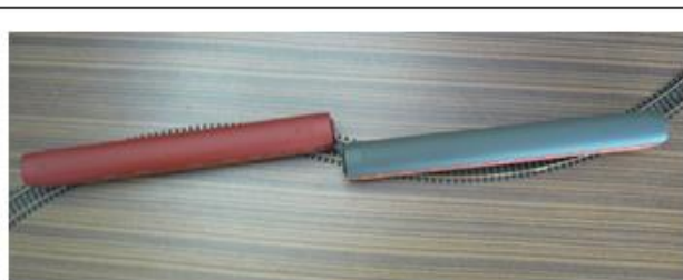
PHOTOS 7 et 8 : exemple de courbe et contre-courbe de 357,5 mm de rayon avec deux voitures à voyageurs HO de 305 mm.
