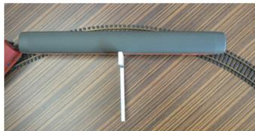
PHOTO 13 et 14 : essai pratique en courbe de 357,5 de rayon (voitures HO de 305 mm).
